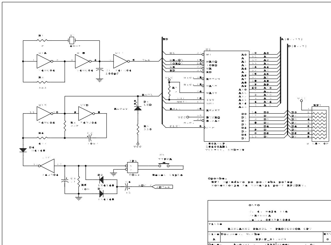
Procesor, oscilator in kontrola procesorja
